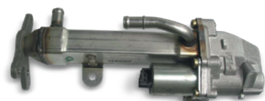
Fig. 1: Valvola EGR con radiatore EGR
